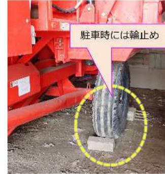
トラクタがひとりだに後進してきたことがあり、それ以来、傾斜がなくても必ず駐車ブレーキをかけるほか、必要時には枕木で輪止めをしている。
