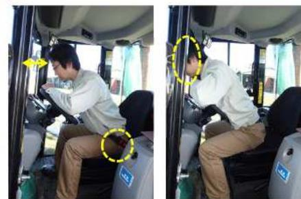
図3 シートベルト有（左）と無（右）での最大前傾姿勢（左のシートベルト有では頭部がフロントガラスに当たらない）
