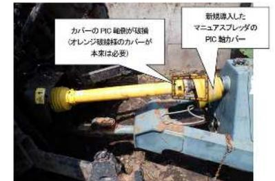
図2 トラクタからトレーラ側油圧ポンプを駆動していたユニバーサルジョイント
