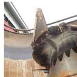
図5 接触したと思われる刃（ホッパー内側断面から高さ約700mm）
