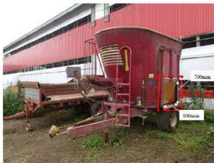
図2 事故機（点線部の給餌口から入って作業していた）
